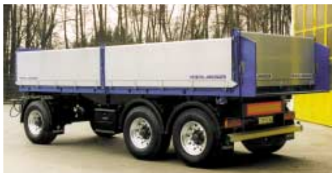
Leichtgewicht in Stahl: 3-Achs 3-Seiten-Kipperhänger, 6.500 i. L., 5.340 kg
