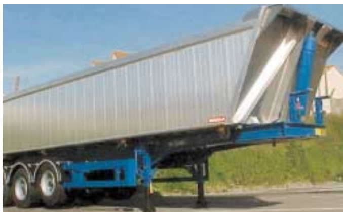
Die Palette des in Aluminium gefertigten Multirunner bietet mit Volumen von 17 bis 80 m 3 optimale Baustellenkipper.
