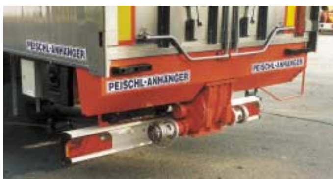
Die am Fahrzeug angebrachte Förderschnecke mit Zellradschleuse und Gebläse bläst das Gut bis in 15 m Höhe.
