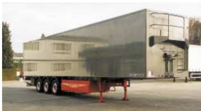
Schubboden-Fahrzeuge von Peischl haben die Nase vorne. Viele Vorteile, vom Ladevolumen bis 100 m 3 bis hin zu einer Beladung von bis zu 30.000 kg zeichnen sie aus.
