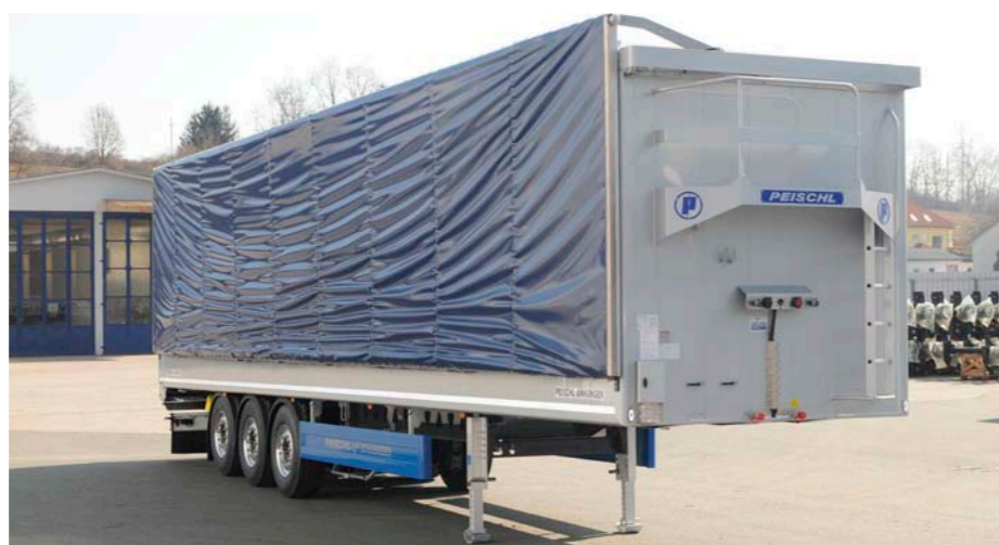
Das patentierte hydraulische Dachsystem ist mittlerweile unverzichtbar bei Hackschnitzel bzw. Holztransporten
