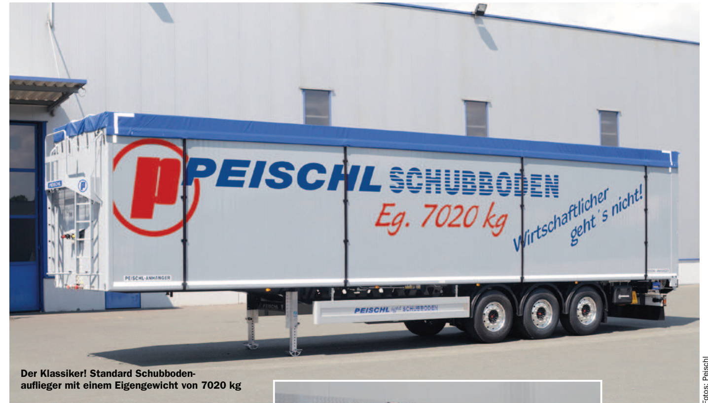
Seitenschutz in formschönem Design, Chassis in Ultralight-Ausführung mit gelaserten Aussparungen
