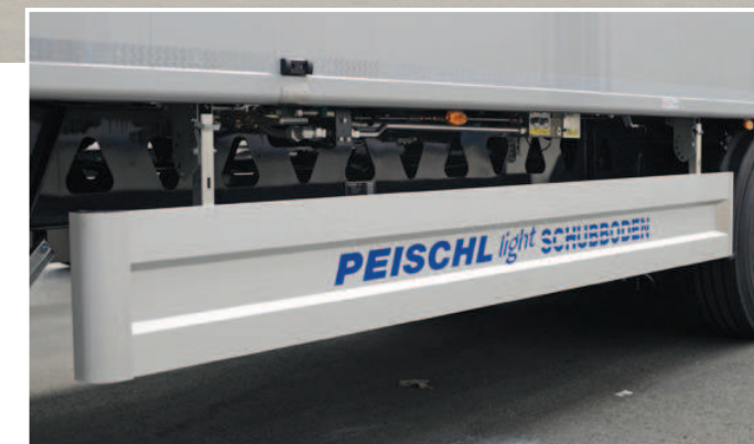
Seitenschutz in formschönem Design, Chassis in Ultralight-Ausführung mit gelaserten Aussparungen
